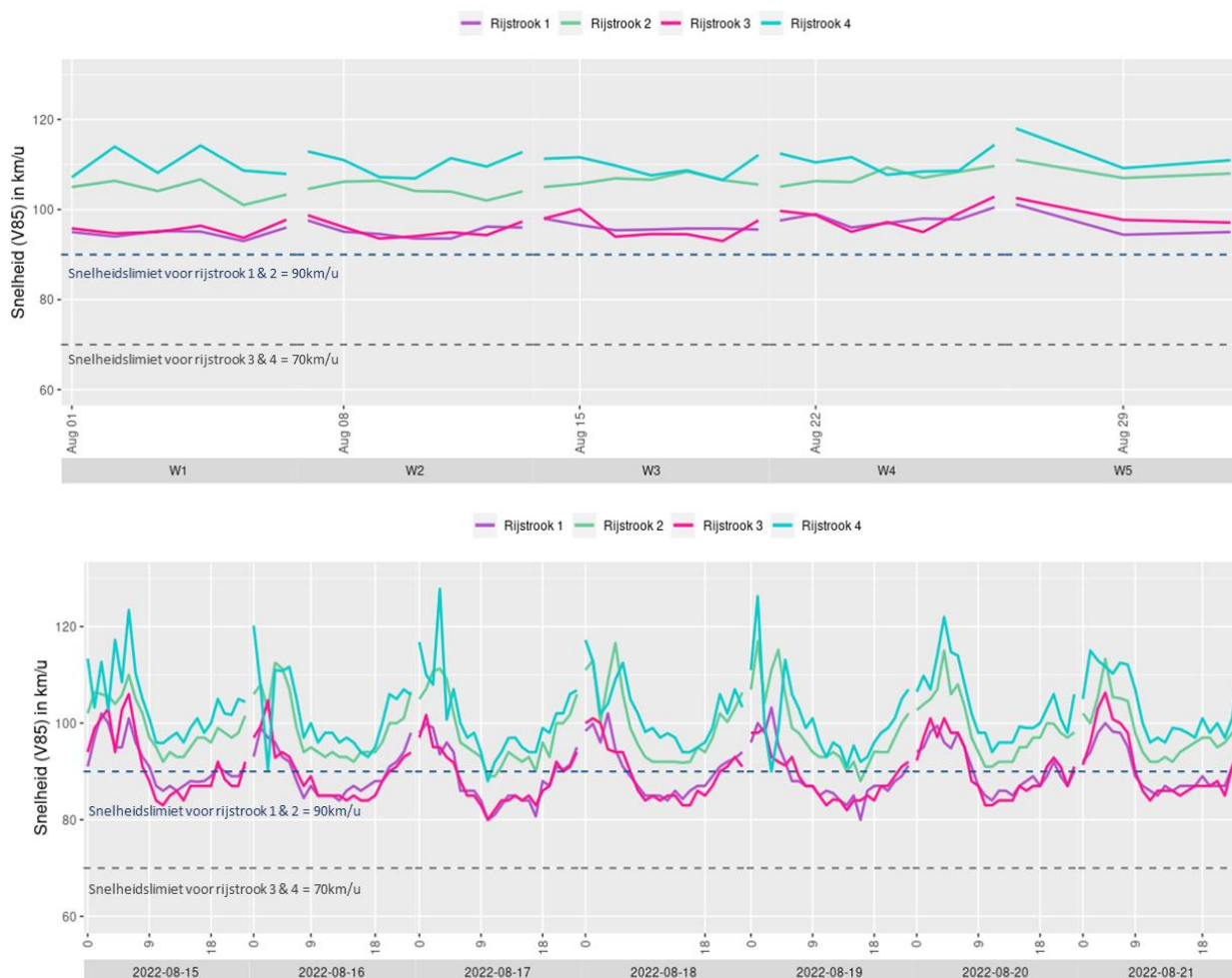
Figuur 50 V85 per week op maandbasis (boven) en per uur per dag op weekbasis (onder) in de richting van Luik ter hoogte van de wegenwerken op de E40 in Bertem
